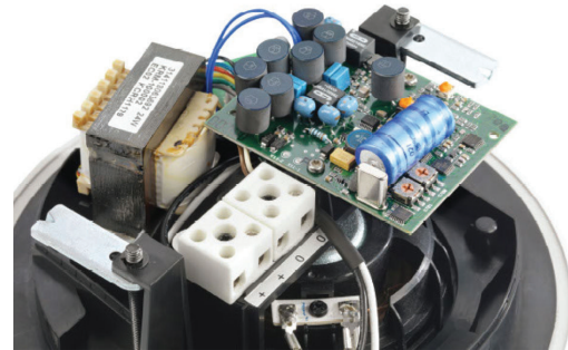
Вид задней части громкоговорителя LC4-UCxxE (с установленной дополнительной платой контроля линии)
